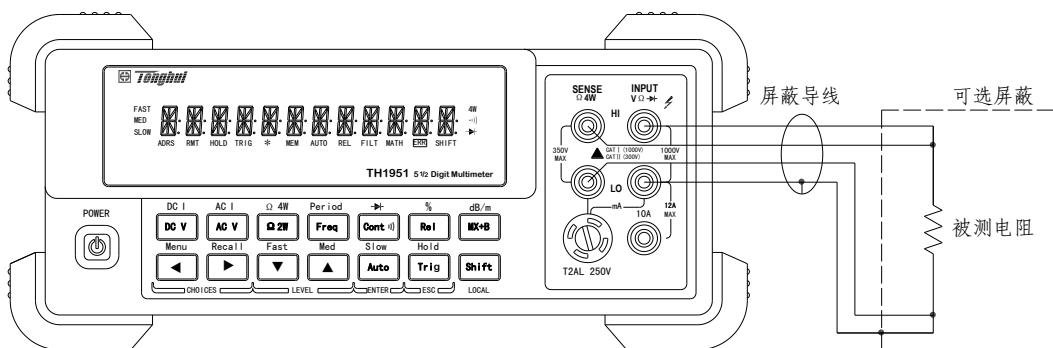
注意：电流源流经 INPUT HI, DUT, INPUT LO 端。
