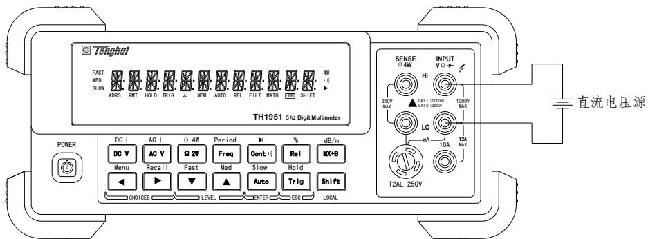
输入阻抗 =  $10M\Omega$  在 1000V 和 100V 量程
