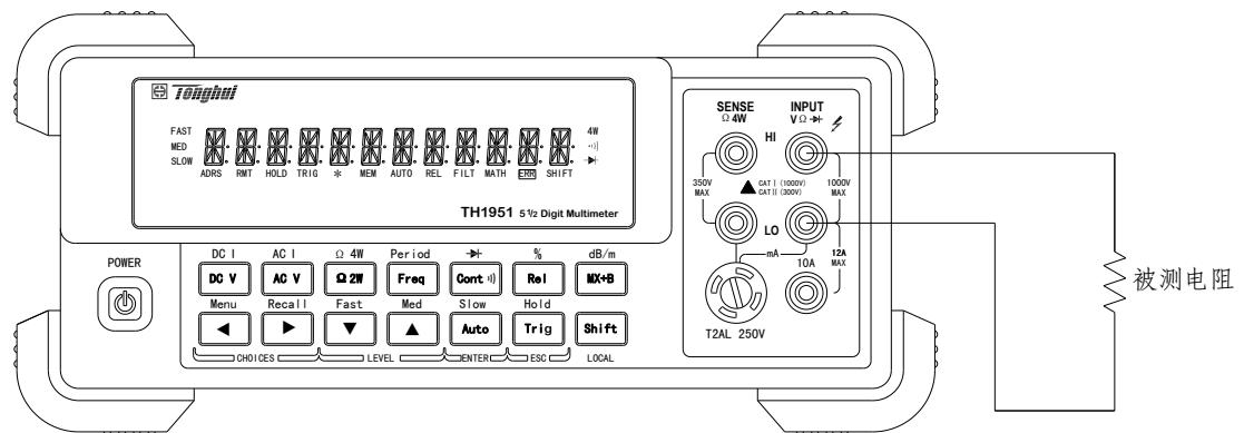
注意：电流源流经 INPUT HI, DUT, INPUT LO 端。
