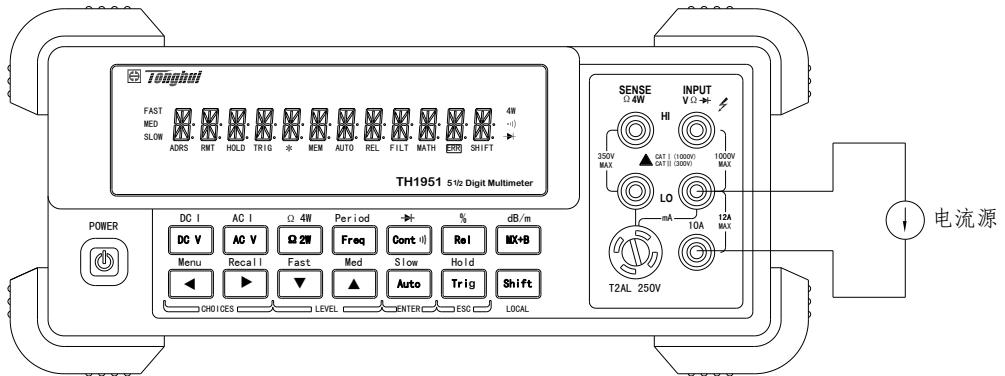
注意：最大输入=12A直流电流或真有效值电流
