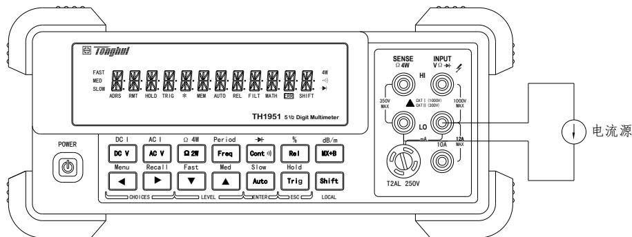
在 10mA, 100mA, 1A 量程的连接方式
