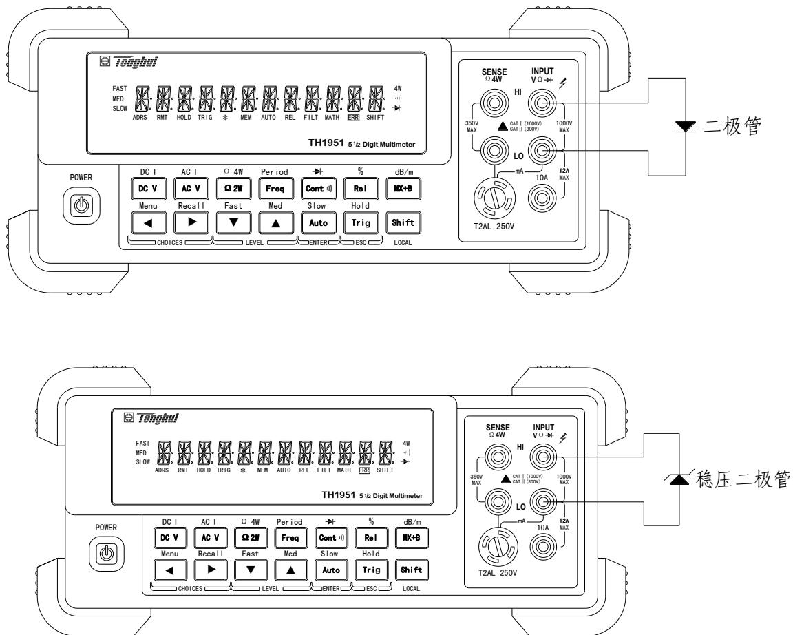
注意：电流源流经 INPUT HI, DUT, INPUT LO 端。
